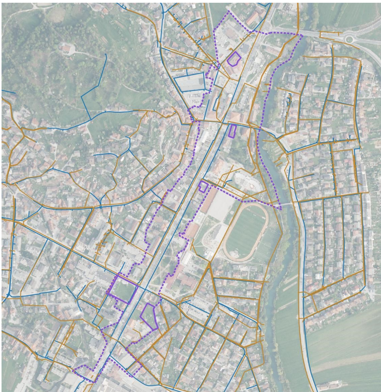
Slika 5: Gospodarska javna infrastruktura – vodovodno (—) in kanalizacijsko omrežje (—) na območju SD OPPN. Vir: GURS, studioFORMIKA, junij 2025.
